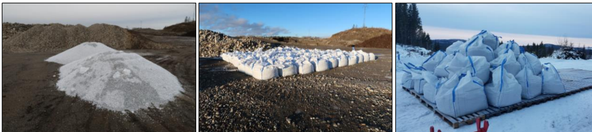
Figur 4. Kalkstein og de to fraksjonene av naturgrus ble blandet til en homogen blanding i grustaket, og så lesset opp i 99 storsekker. Deretter ble de fraktet om høsten opp til helikopterdepotet nær Øyangen, for videre frakt med helikopter ut på sjøen på ettervinteren. Foto: Huvo og Øystein Løvli.
