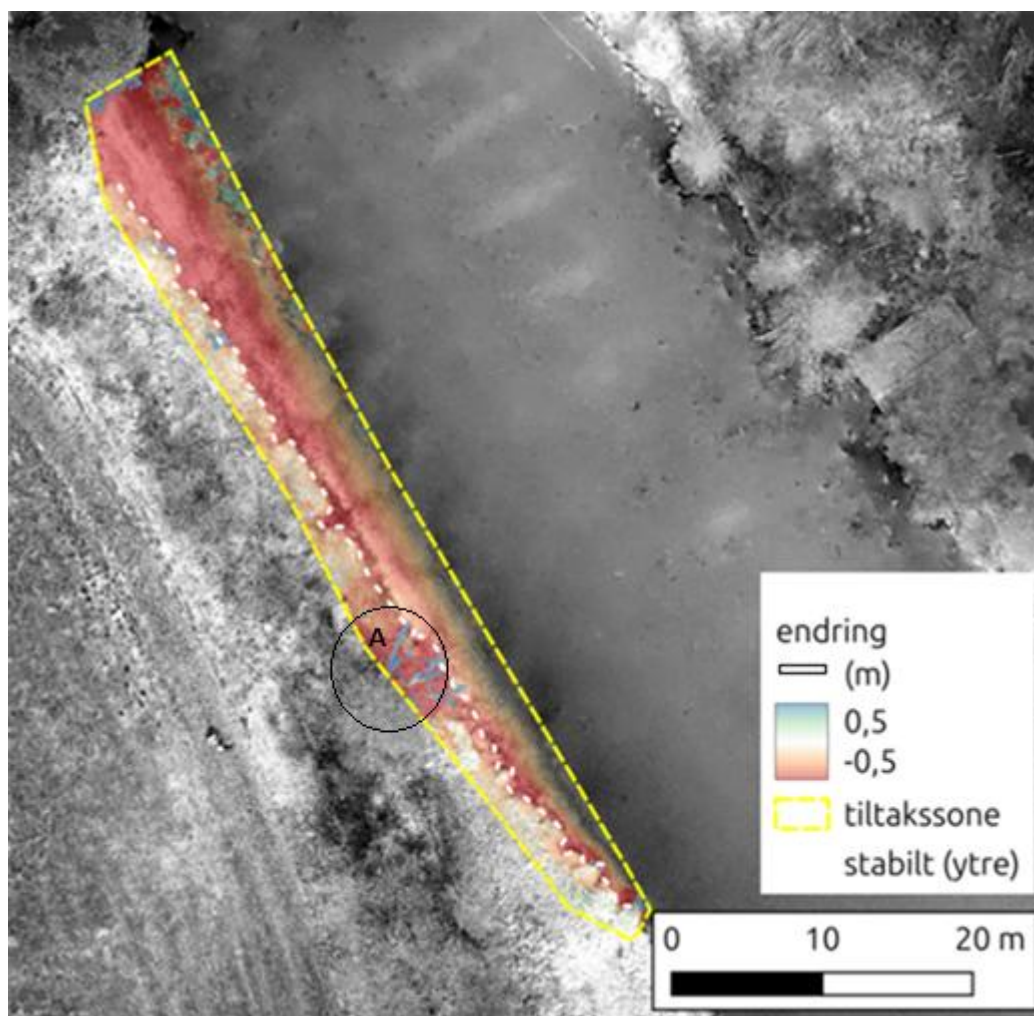
Figur 15. Endring i terreng høyde mellom 2023 og 2025. Hvit stiple linje viser ytre grensen til tilstøtende kantsone og fargeskalaen indikerer endring i topografi. Analysen viser at tilstøtende kantsone er relativt stabil, men om området markert A har terrenget sunket noe sammen.
